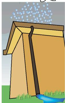
Los canales de desagüe deben mantenerse limpios de desechos para que puedan funcionar correctamente, para esto deben ser examinados regularmente, y así evitar posibles fugas de agua.
